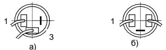
Рисунок 2. Вид на кнопки со стороны подключения кабелей: а) для кнопок 2812.3710; б) для кнопок 2822.3710
